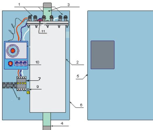
Теплообменник представляет собой цилиндрический сосуд с укрепленными в нём электронагревателями (ТЭНами), имеющий два отверстия: для подвода и отвода теплоносителя.
